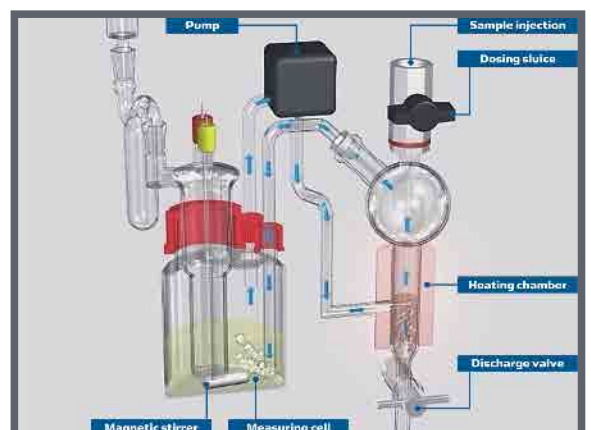
Circulación del gas portador en lazo cerrado combinado con el módulo de extensión
